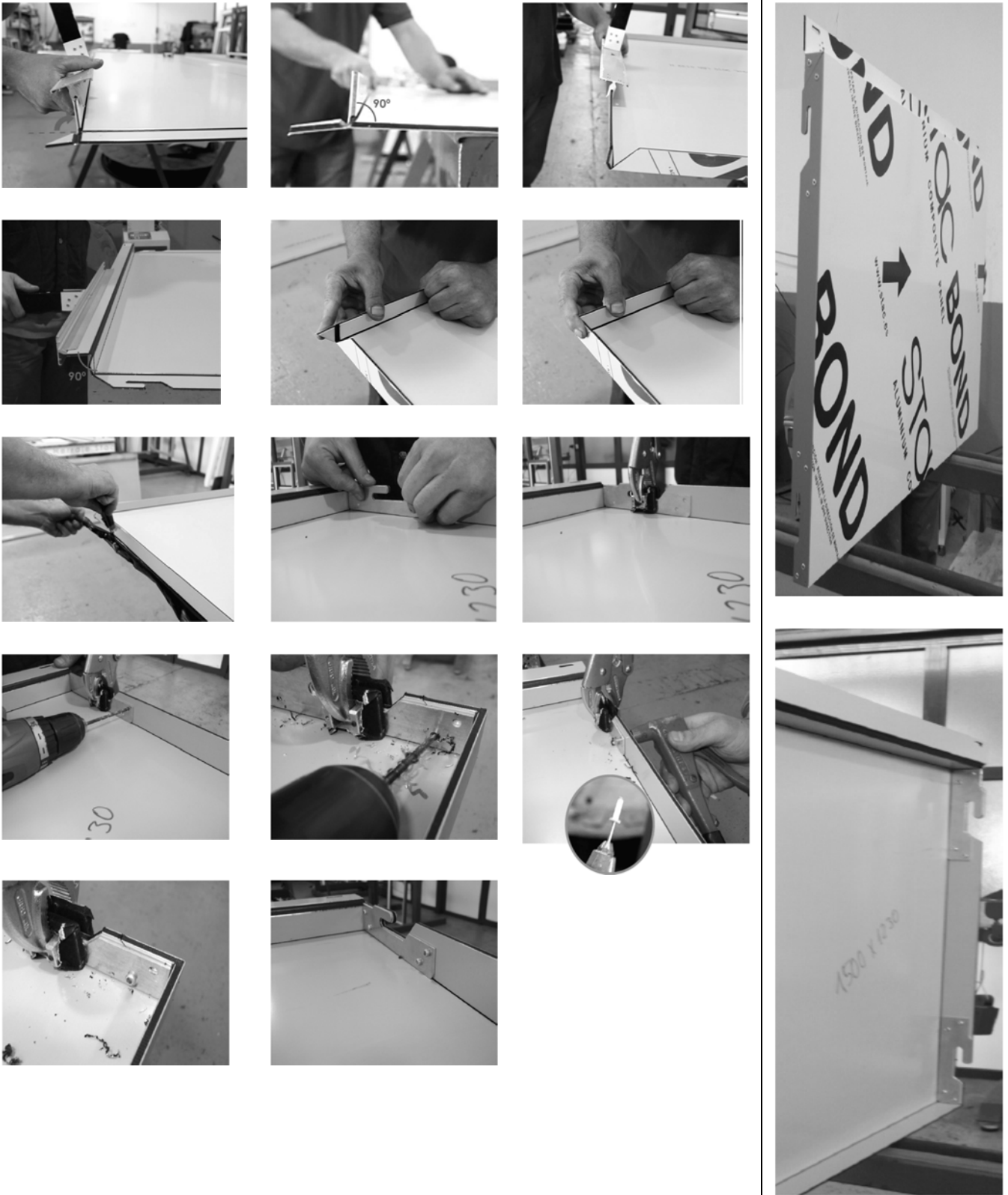
Figure 2b – Façonnage des cassettes (Usinage/Assemblage)
